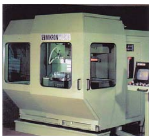
FRESATRICE CNC MIKRON WF 51C CONTROLLO HEIDENHAIN (x 800 y 500 z 400)
